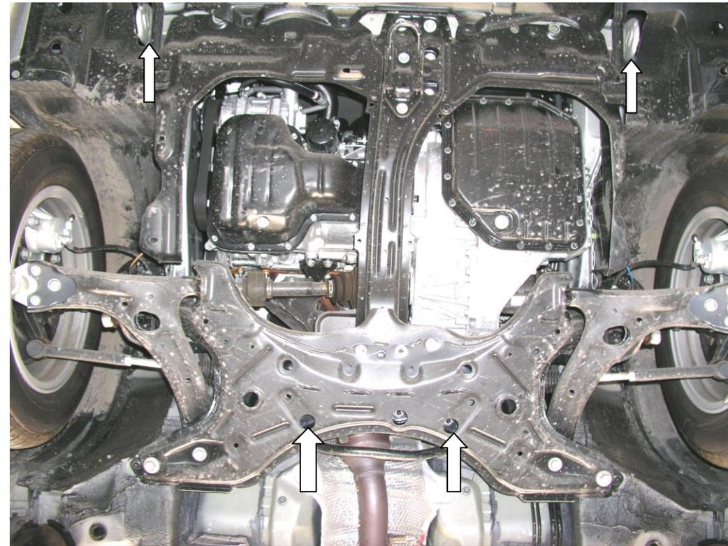
1. Снять штатный пыльник.
